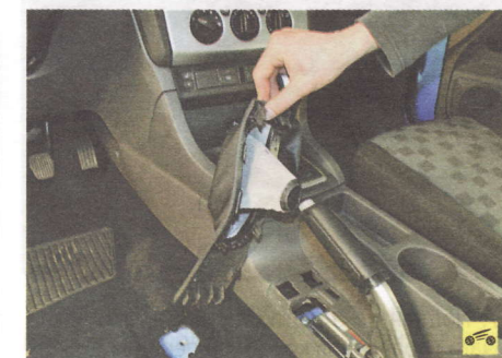
3. ...отсоедините рамку от облицовки тоннеля пола, преодолевая упругое сопротивление ее фиксаторов, и снимите чехол с рычага.
