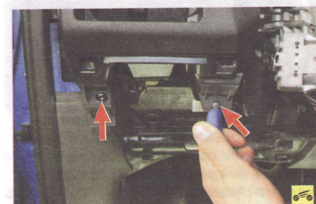
31. ...извлеките разъем из отверстия накладки и снимите накладку.
