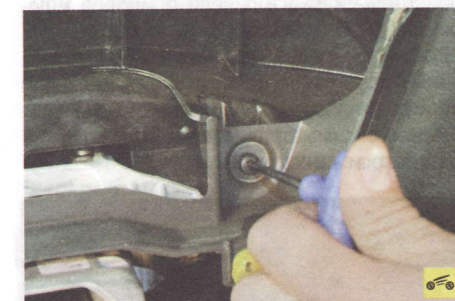
35. ...винт в проеме для комбинации приборов...
