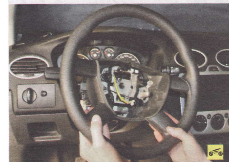
2. Снимите рулевое колесо (см. «Снятие и установка рулевого колеса», с. 163).
