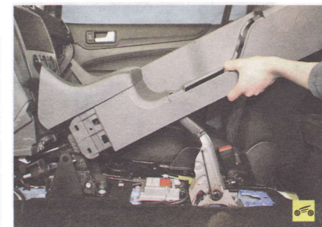
5. Снимите облицовку тоннеля пола (см. «Снятие и установка облицовки тоннеля пола», с. 261).
