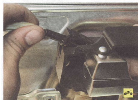
5. ...извлеките упор из корпуса ручки.
