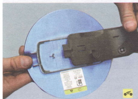
11. ...и отсоедините крышку от кронштейна.
