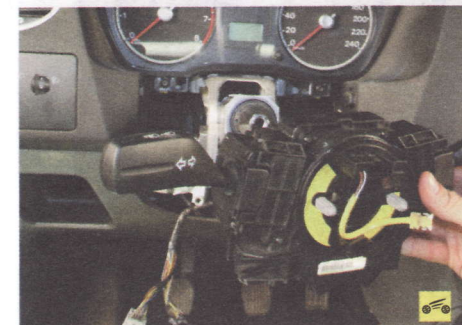
3. Снимите подрулевые переключатели в сборе с соединителем (см. «Замена подрулевых переключателей», с. 218).
