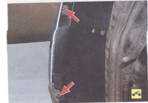
5. ...и по два передних винта крепления подкрылков к бамперу...
