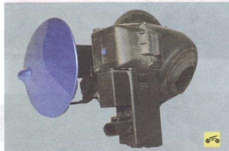
9. ...и снимите крышку в сборе с кронштейном и уплотнителем.
