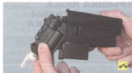
4. ...и извлеките замок из кожуха. 5. Установите детали в порядке, обратном снятию.
