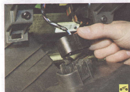
31. ...извлеките разъем из отверстия накладки и снимите накладку.
