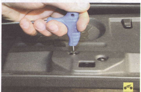
17. При необходимости выверните два винта крепления замка крышки вещевого ящика...
