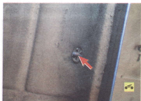
3. ...и снимите брызговик заднего колеса.
