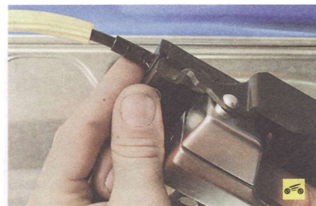
4. Нажав снизу на упор оболочки троса привода замка...
