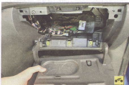
21. ...и снимите крышку вещевого ящика, выводя ее рычаги из пазов панели приборов.
