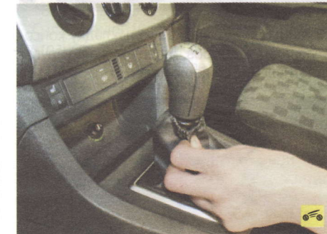
5. Снимите чехол с рукоятки рычага управления коробкой передач...
