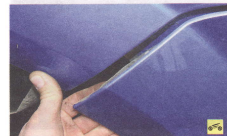
12. Потянув наружу, отсоедините держатели концов бампера от кузова...
