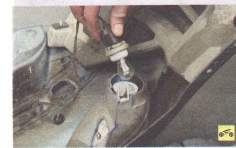
15. ...и извлеките патроны вместе с лампами из обоих фонарей.
