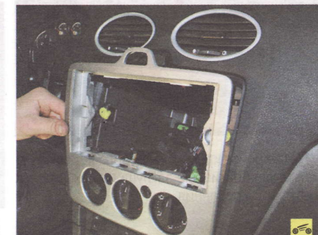
11. ...и снимите центральную накладку.
