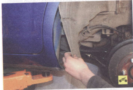
8. Сдвиньте подкрылок со шпилек...
