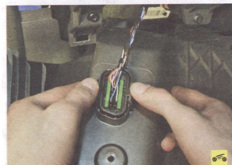
30. ...с обратной стороны накладки разожмите фиксаторы диагностического разъема...
