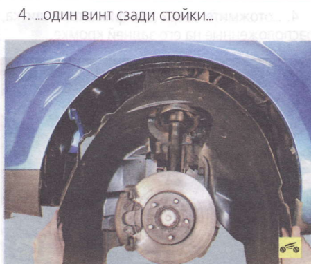
5. ...и снимите подкрылок.
