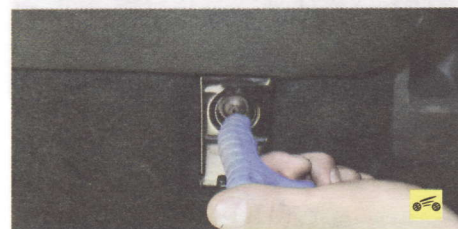
1. Выверните два болта (показан крайний болт, второй болт на фото не виден, он расположен ближе к центру автомобиля) крепления подушки заднего сиденья...
