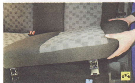
2. ...и извлеките подушку заднего сиденья из салона автомобиля.
