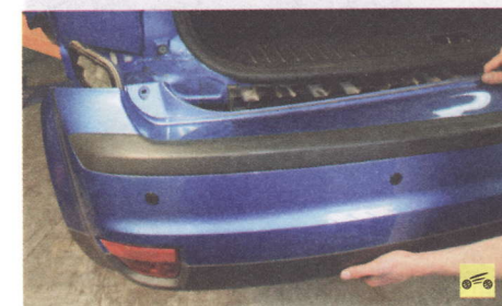
13. ...и снимите задний бампер.
