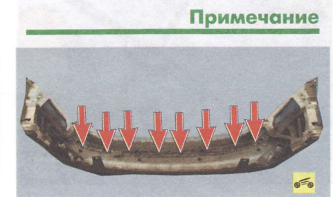
Так расположены держатели жгута проводов на заднем бампере.
