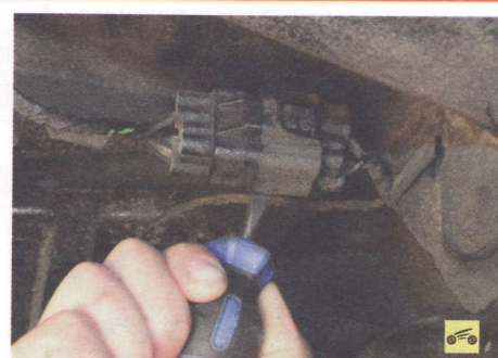
2. Снизу автомобиля в его правой задней части отсоедините от кронштейна колодку жгута проводов фонаря света заднего хода и заднего противотуманного фонаря, поддев ее отверткой.
