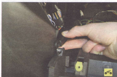
20. ...снимите с пальца левого рычага крышки вещевого ящика наконечник штока пневмоупора...
