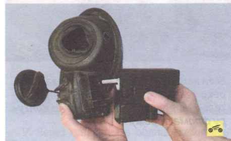
3. ...отсоедините кожух от кронштейна крышки...
