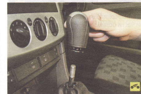
6. ...и свинтите рукоятку с резьбового хвостовика рычага.
