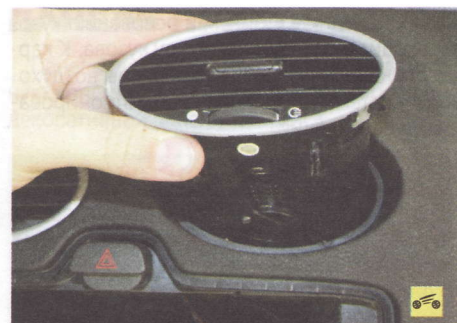
23. ...и снимите два центральных и два боковых сопла системы отопления (кондиционирования) и вентиляции. Все четыре сопла снимают одинаковыми приемами.
