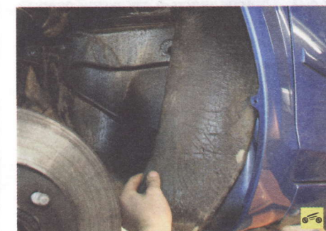
4. Удалите из полости крыла шумоизоляцию.
