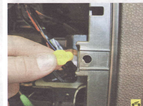
7. Через два отверстия в заглушке гнезда для установки магнитолы отожмите фиксаторы...
