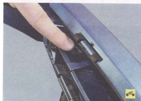
15. ...отожмите вниз по два боковых фиксатора и отведите края бампера от каркаса моторного отсека.
