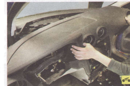
39. ...и снимите декоративную панель, отсоединив от ее внутренней стороны держатели жгута проводов.
