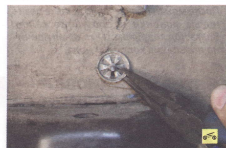
2. Захватив пассатижами, снимите со шпилек кузова...
