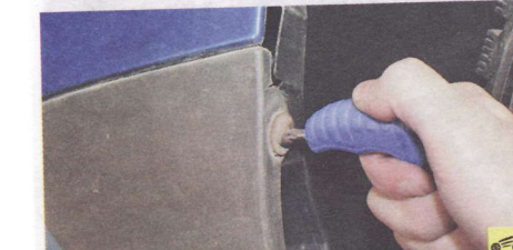
3. ...и снимите брызговик заднего колеса.
