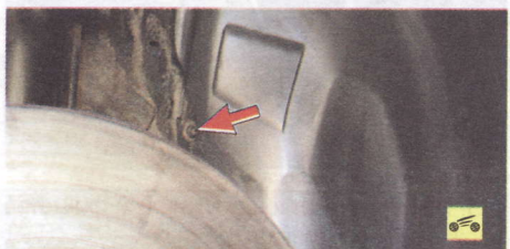
3. ...и снимите брызговик заднего колеса.
