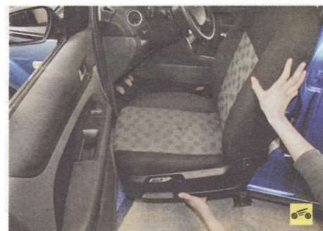
6. Выньте сиденье из салона автомобиля. 7. Установите сиденье в порядке, обратном снятию. Перед установкой нанесите на болты крепления сиденья анаэробный фиксатор резьбы.
