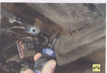
5. Поддев отверткой держатель жгута проводов фонаря света заднего хода и заднего противотуманного фонаря...
