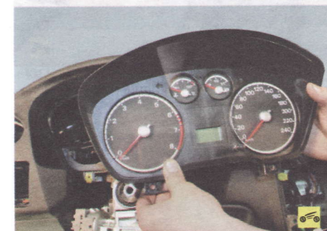
4. Снимите комбинацию приборов (см. «Снятие и установка комбинации приборов», с. 226).
