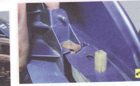
14. ...и утопите защелки в отверстия каркаса...
