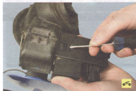
2. Для замены замка крышки отожмите фиксатор кожуха замка...
