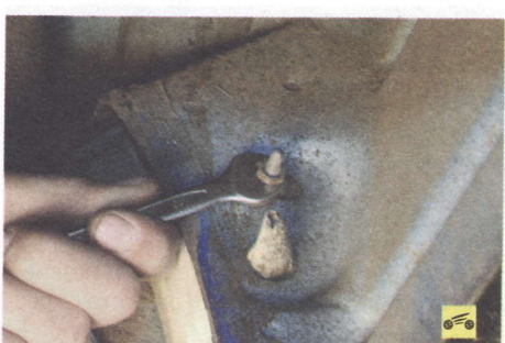
10. Изнутри обеих арок задних колес отверните по одной гайке крепления концов бампера к кузову.
