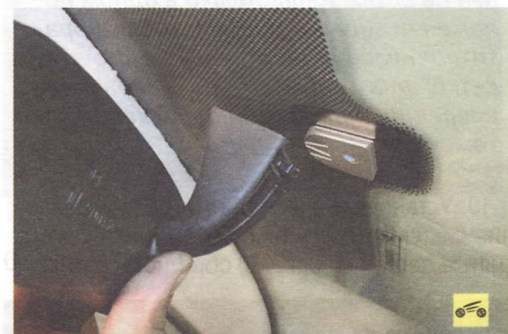
2. ...и снимите зеркало, сдвинув его с кронштейна вверх вдоль стекла.
