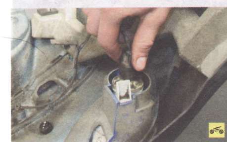
14. Если задний бампер снят для замены, снимите с него фонарь света заднего хода, противотуманный фонарь и жгут проводов, а затем установите их на новый бампер. Для этого поверните патроны ламп фонаря света заднего хода и противотуманного фонаря против часовой стрелки...
