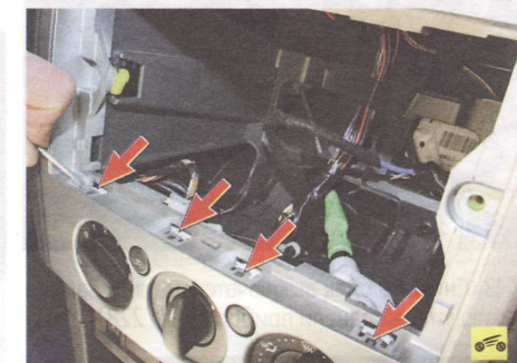
10. ...отожмите отверткой вверх четыре фиксатора...
