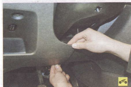
28. ...отсоедините край левой накладки от панели приборов...
