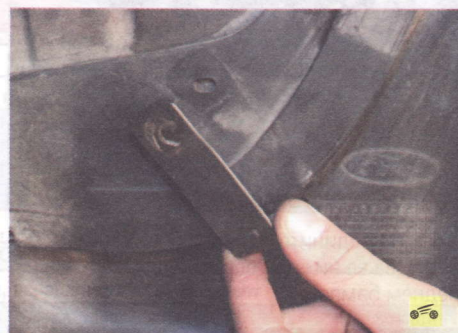
2. ...одновременно снимая держатели брызговика, установленные под тремя наружными винтами...
