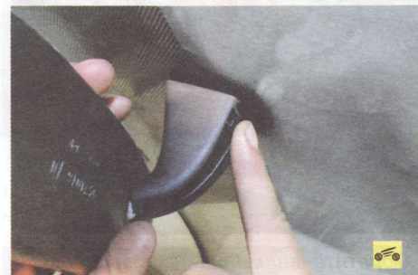
1. Поверните пальцем фиксатор на опоре зеркала...
