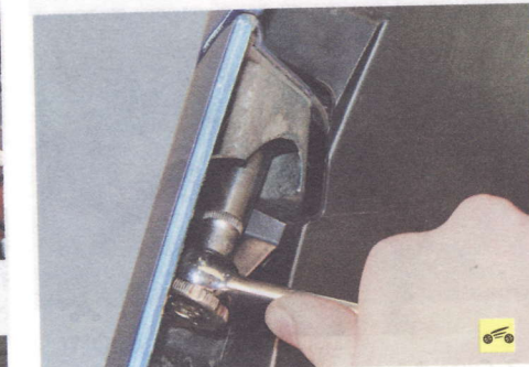
6. ...а также по два болта наружного крепления переднего бампера к передним крыльям.
