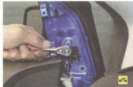
9. ...и нижний болт крепления наружного зеркала...
