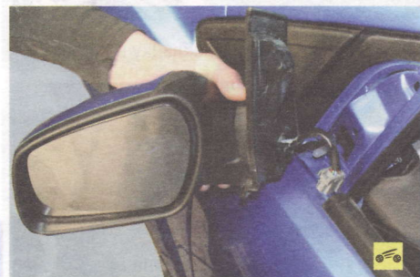
10. ...затем снимите зеркало...
