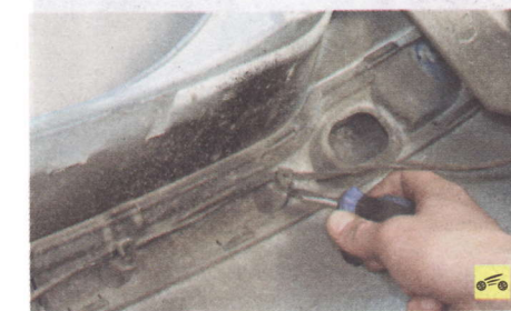
15. ...и извлеките патроны вместе с лампами из обоих фонарей.
