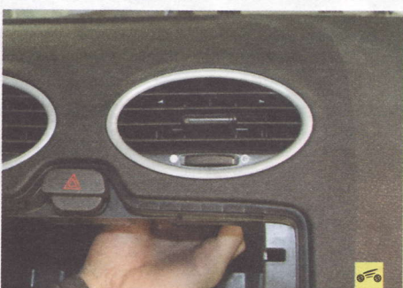
22. Изнутри панели приборов отожмите наружу...
