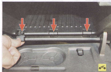
14. Откройте крышку вещевого ящика и отвинтите декоративные заглушки трех нижних винтов его крепления.
