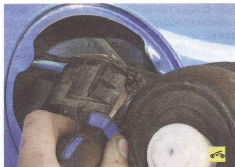
7. Поддев отверткой держатель жгута проводов...
