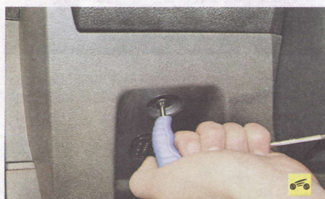
26. Выверните винт крепления левой накладки панели приборов...
