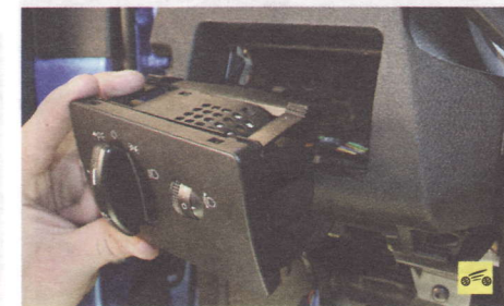
6. Снимите блок управления наружным освещением (см. «Снятие и установка блока управления наружным освещением», с. 227).
