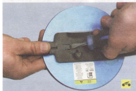
10. Отожмите отверткой фиксатор...
