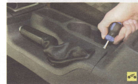
6. ...и свинтите рукоятку с резьбового хвостовика рычага.
