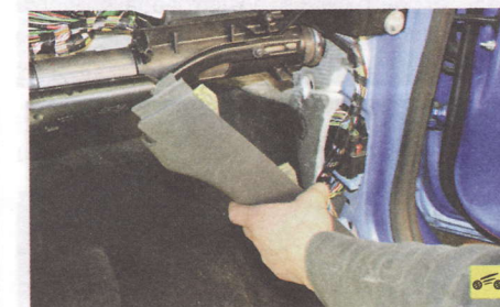
40. Снимите правую и левую передние облицовки порогов (см. «Снятие и установка облицовок салона», с. 276).
