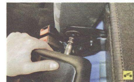
5. Извлеките ось внутреннего шарнира из кронштейна и снимите спинку заднего сиденья.
