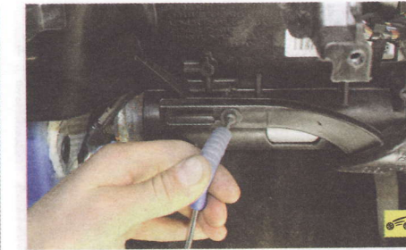
42. Выверните винт крепления левого воздуховода к каркасу панели приборов...
