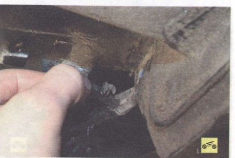
5. Поддев отверткой держатель жгута проводов фонаря света заднего хода и заднего противотуманного фонаря...
