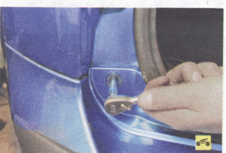
10. Изнутри обеих арок задних колес отверните по одной гайке крепления концов бампера к кузову.
