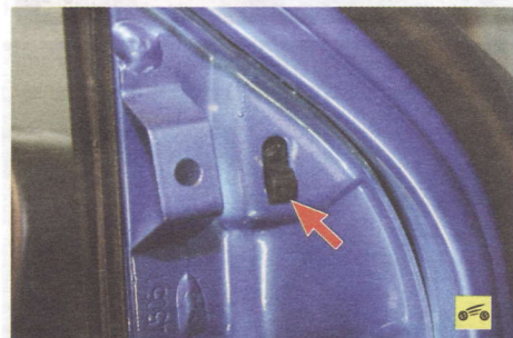
11. ...выведя крючок на его основании из отверстия в панели двери.
