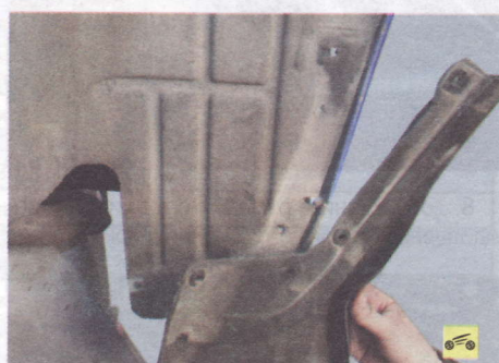
3. ...и снимите брызговик заднего колеса.
