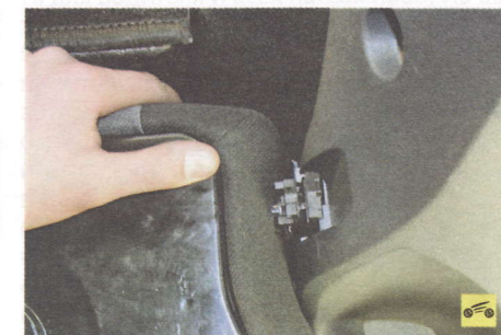
4. ...и отсоедините шарнир от кронштейна.
