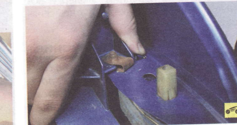
13. ...с обеих сторон отожмите пальцем две защелки бокового крепления бампера к каркасу моторного отсека...
